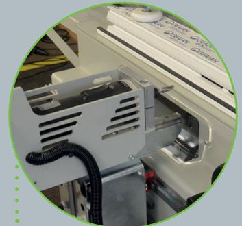
fraisage de l'avant du boîtier de serrure... avec moteur standard
