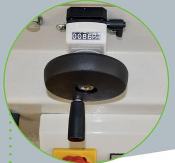
Position réglable de perçage et fraisage... réglable via roue à main
